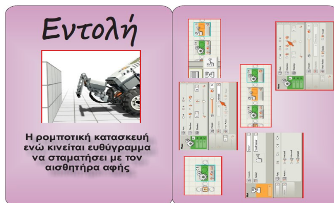
Εικόνα 3. Κάρτα με οδηγίες για την κίνηση και το σταμάτημα της ρομποτικής συσκευής με τον αισθητήρα αφής
